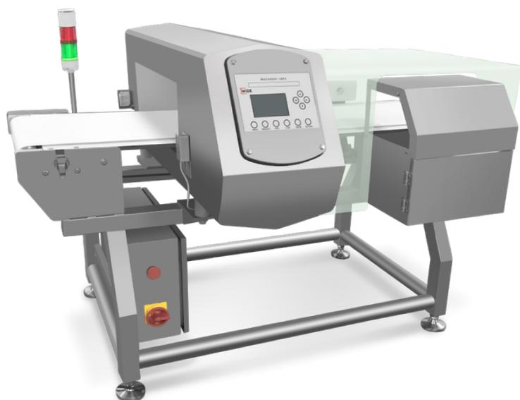
Os Detetores de Metais têm como função garantir que os produtos alimentares estão completamente livres de contaminação metálica, detetando com precisão as mais pequenas partículas.
